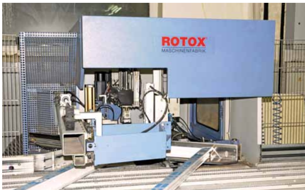
▲ Зачистка сварного шва на автоматической линии
