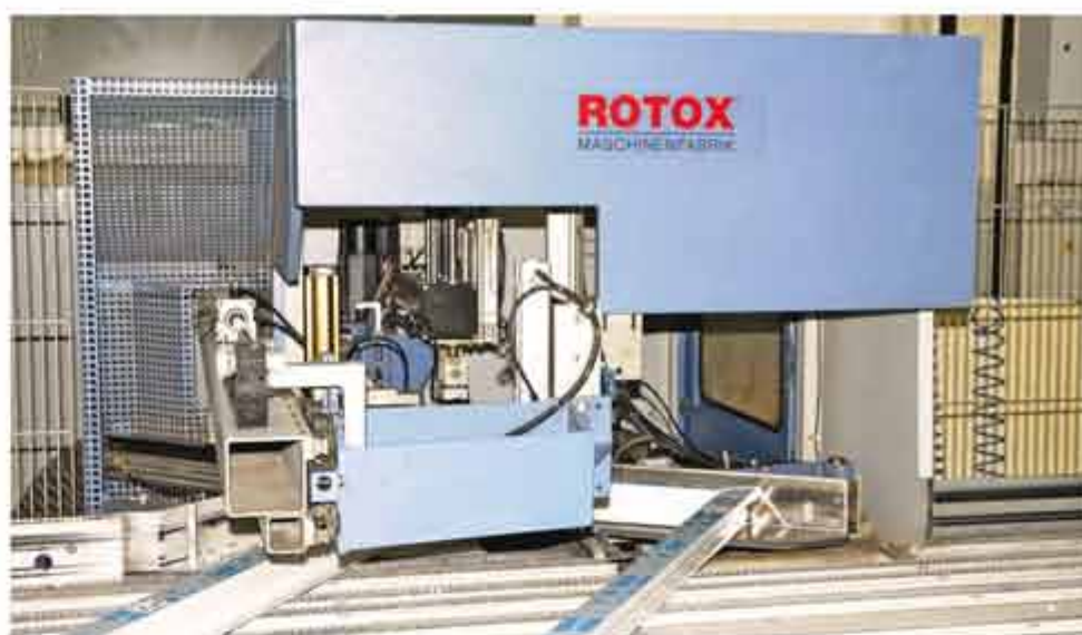
— Зачистка сварного шва на автоматической линии
