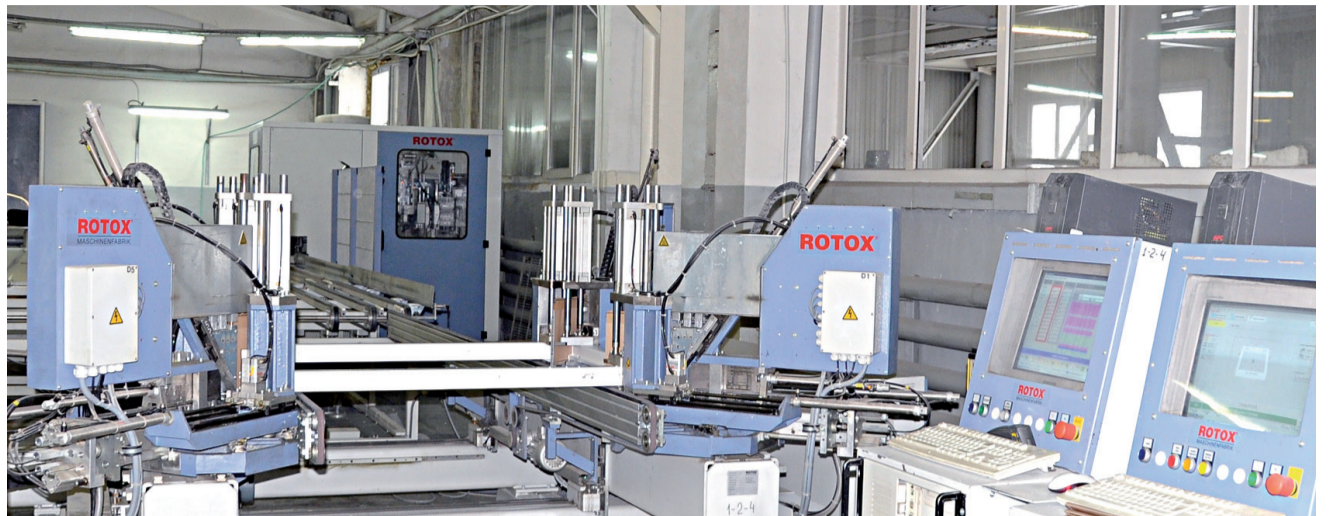
▲ Одновременная сварка углов на четырехголовочном автомате обеспечивает идеальную геометрию рамы и створки окна
