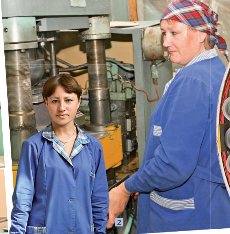
1, 2 Людмила Степанова формирует на прессовальном станке полусферы 3 Ольга Геронтьева подбирает полусферы друг к другу и проверяет соединение шва 4 Мастер Марина Ильина демонстрирует готовую продукцию
